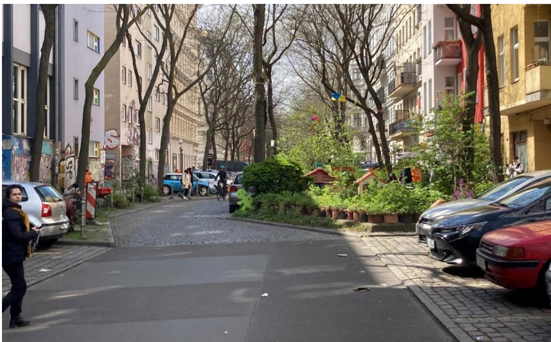
Zdjęcie 8. Berlin, Böckhstraße – zwężenie jezdni (szykana) wykorzystane do budowy skweru
